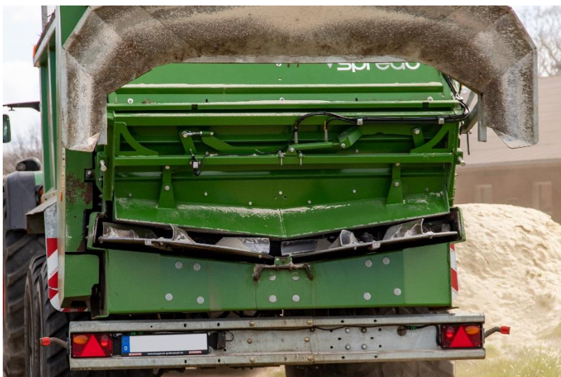
Рисунок: Новая регулировка маятникового устройства крышки: здесь установлена гидравлическая регулировка в сочетании с широкозахватной системой V-Spread .
