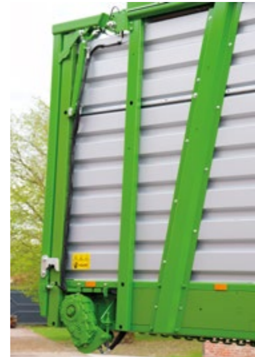
Beidseitiger Transportbodenantrieb mit Eilgangschaltung
