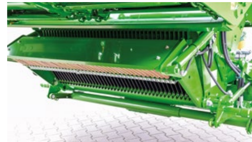
53 Messer in einer Ebene, 34 mm Schnittlänge
