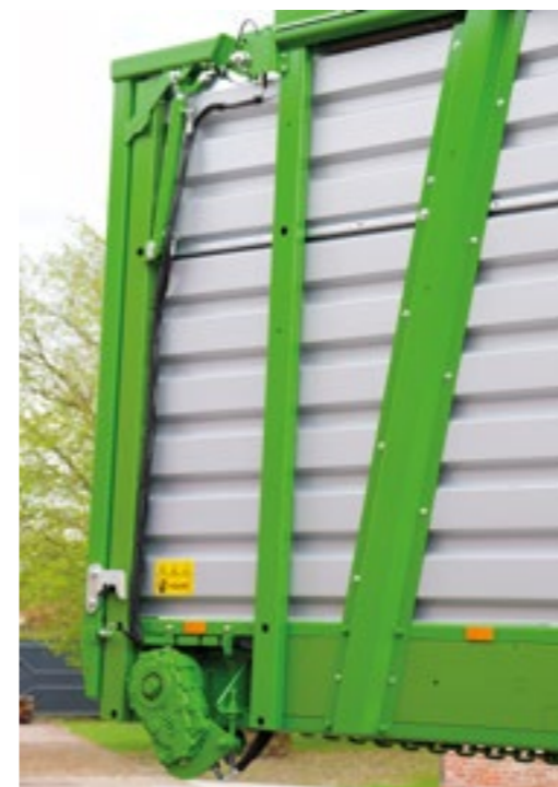
Beidseitiger Transportbodenantrieb mit Eilgangschaltung
