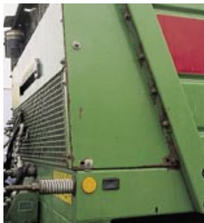
Die federbelasteten Spanner sind einfach zugänglich. Der Lack ist gerade bei älteren Streuern nicht überzeugend.
