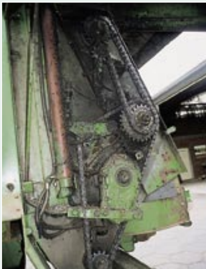
Wenn es eine Zentralschmierung oder wenigstens einen Öler gibt, ist der Antrieb der Streuwalzen unproblematisch.
