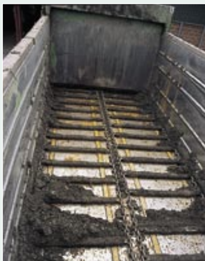
Die 14 x 50-mm-Ketten mit jeweils 25 t Bruchlast reißen eigentlich nie. Auch die großen Ketten-Antriebsräder und die U-Profile machen wenig Ärger.
