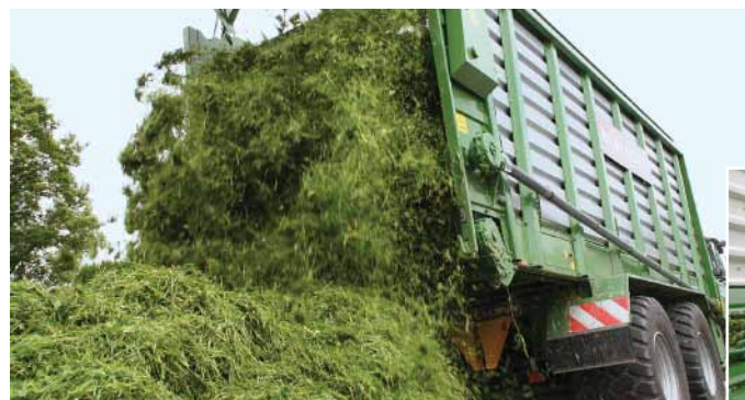
Unsere Testmaschine verfügte in der Ausführung „S“ über drei Dosierwalzen. Der Öffnungswinkel der Heckklappe wird vorne an der Stirnwand dargestellt. Die Sensoren für die Steuerung der Beladeautomatik des Transportbodens befinden sich an der Stirnwandklappe und an der unteren Dosierwalze.
