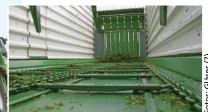
Unsere Testmaschine verfügte in der Ausführung „S“ über drei Dosierwalzen. Der Öffnungswinkel der Heckklappe wird vorne an der Stirnwand dargestellt. Die Sensoren für die Steuerung der Beladeautomatik des Transportbodens befinden sich an der Stirnwandklappe und an der unteren Dosierwalze.
