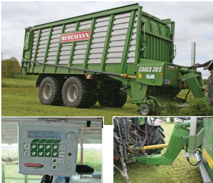
Der Carex bietet für nasse Bodenverhältnisse die Möglichkeit der Entlastungsfunktion für die Pick-up. Die Knickdeichsel lässt sich von außen heben und senken. Standardmäßig wird der Wagen mit dem BCT-Terminal bedient. Wir haben uns aber auch die ISOBUS-Varianten angesehen.
