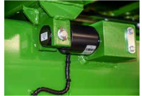
Dieser neue Einachs-Streuer 2140, mit einem zul. Gesamtgewicht von 14 t, hat keine klassische Brückenwaage mehr, sondern die Achse liegt auf Wiegestäben und die Stützlast wird vorn mit einer Messzugöse gemessen.
