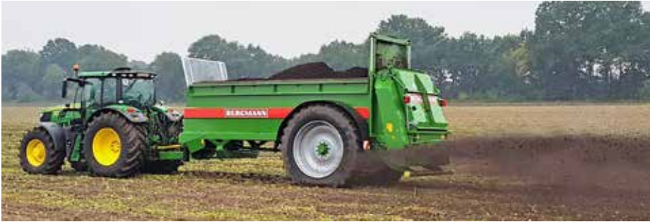
Dieser neue Einachs-Streuer 2140, mit einem zul. Gesamtgewicht von 14 t, hat keine klassische Brückenwaage mehr, sondern die Achse liegt auf Wiegestäben und die Stützlast wird vorn mit einer Messzugöse gemessen.
