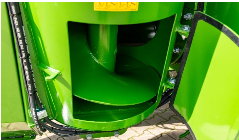
Рисунок: Удобный доступ для оптического контроля и очистки места сопряжения подающего и перегружающего шнека.
