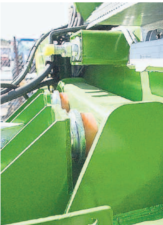
Aisan jousitus on toteutettu neofreeniä-tyynyillä. Rakenne on toimiva, kun ensimmäinen vaunu on yli 10 vuotta vanha ja tyynyt ovat edelleen kunnolliset, vakuuttaa Isaksson
