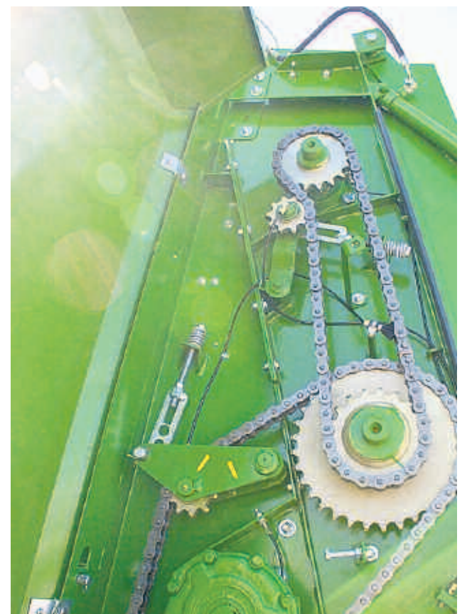
Levityskeloja pyörittäviä ketjuja voidellaan automaattisesti aina kun ne pyörivät. Jatkuva voitelu takaa pitkän iän rankassa urakointikäytössäkin.
