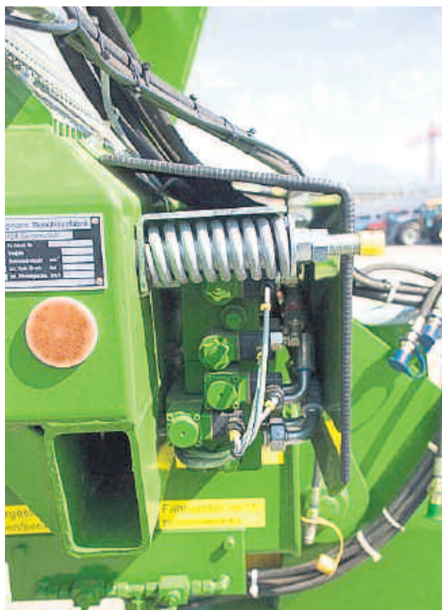
Pohjakuljettimen ketjut kiristetään etukulmista. Ketjuissa on jousikiristys.
