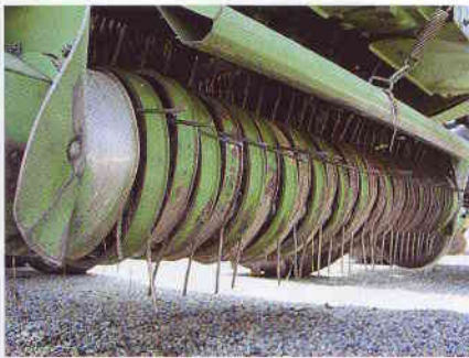
Stark abgenutzte Pickup: Steuerrollen und Zinken sollte man sich genauer ansehen.
