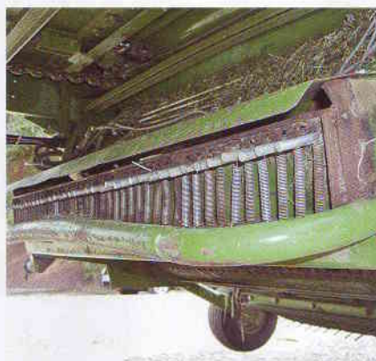
Dieser Messerbalken wurde durch ein Flacheisen oberhalb der Messersicherungen verstärkt.
