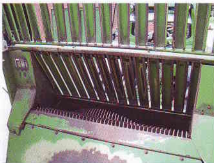
Durch die zwei übereinander angeordneten Rotoren liegt der Übergabepunkt des Futters in den Laderaum recht hoch.
