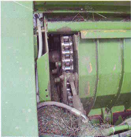
Die Rollenketten des Rotor- und Pickup-antriebs werden serienmäßig automatisch mit Öl geschmiert.
