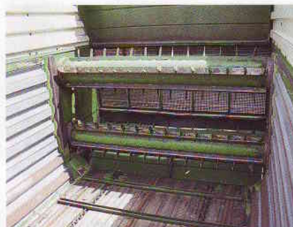
Zwei Dosierwalzen verteilen das Futter auf der Miete. Dieser Wagen hat auch nur zwei statt vier Kettenstränge.
