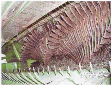
Das Schneid- und Förderaggregat ist mit 41 Messern bestückt.
